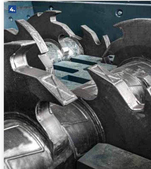
**ASYNCHRONOUS TWIN-SHAFT CUTTING SYSTEM**
