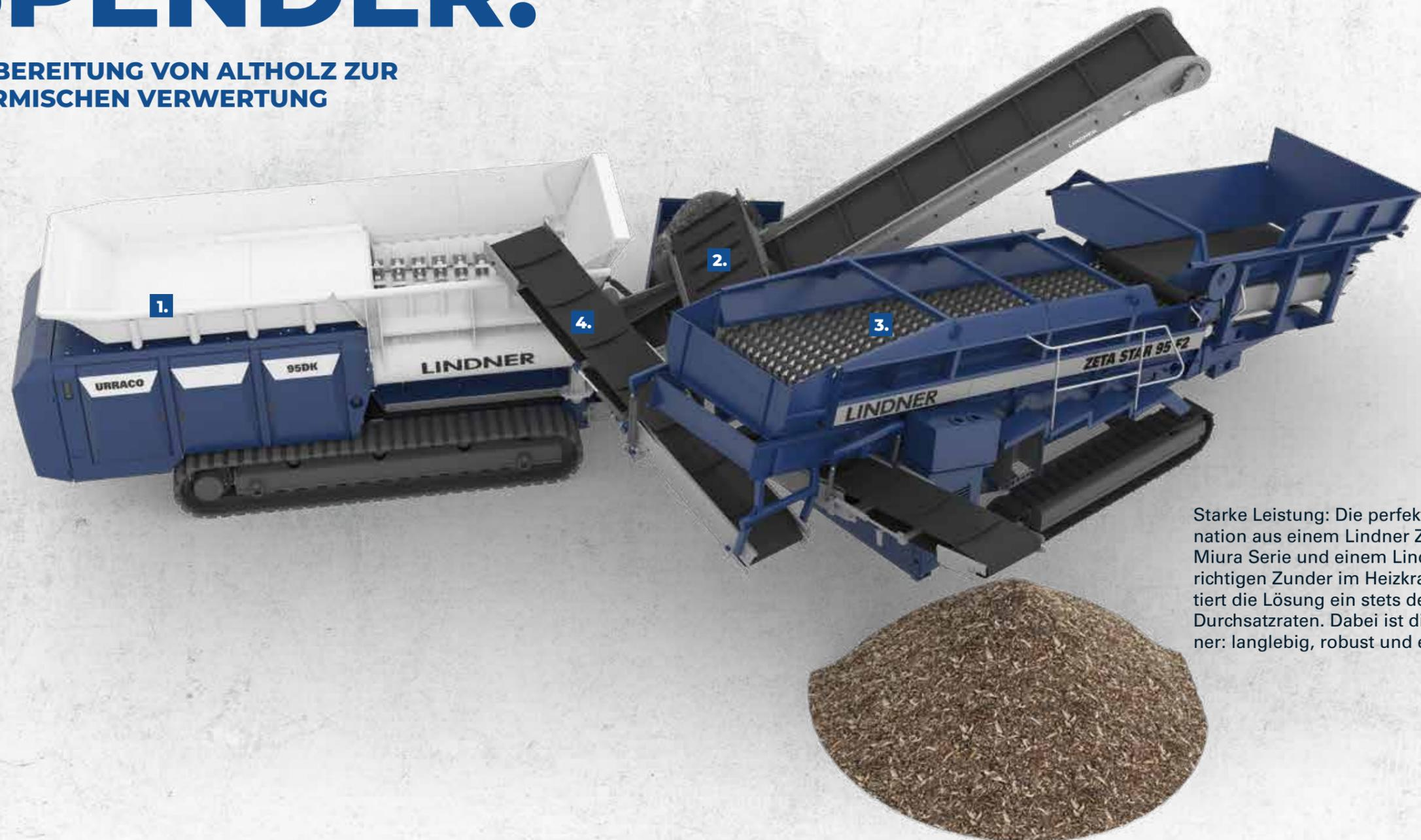
Starke Leistung: Die perfekt aufeinander abgestimmte Kombination aus einem Lindner Zweiwellen-Shredder der Urraco oder Miura Serie und einem Lindner Zeta Star Sieb sorgen für den richtigen Zunder im Heizkraftwerk. Im Zusammenspiel garantiert die Lösung ein stets definiertes Korn bei beeindruckenden Durchsatzraten. Dabei ist die Ausführung natürlich typisch Lindner: langlebig, robust und effizient.
